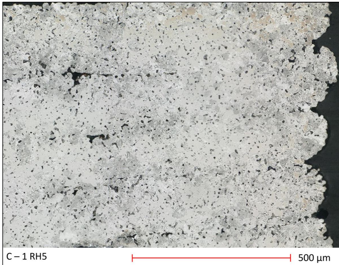
Figure 62 : Répartition du constituant lamellaire pour des échantillons imprimés et frittés en condition C-1 sous azote ou RH5
