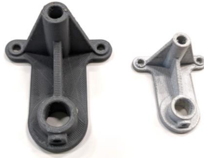
Figure 26 : Illustration du retrait (à gauche, pièce verte ; à droite, pièce frittée)
