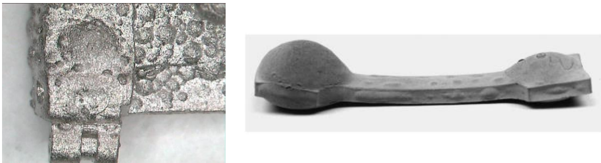
Figure 21 : Exemple de bulles en surface (à gauche) ; Exemple de déformation et de gonflement (à droite) [87]
