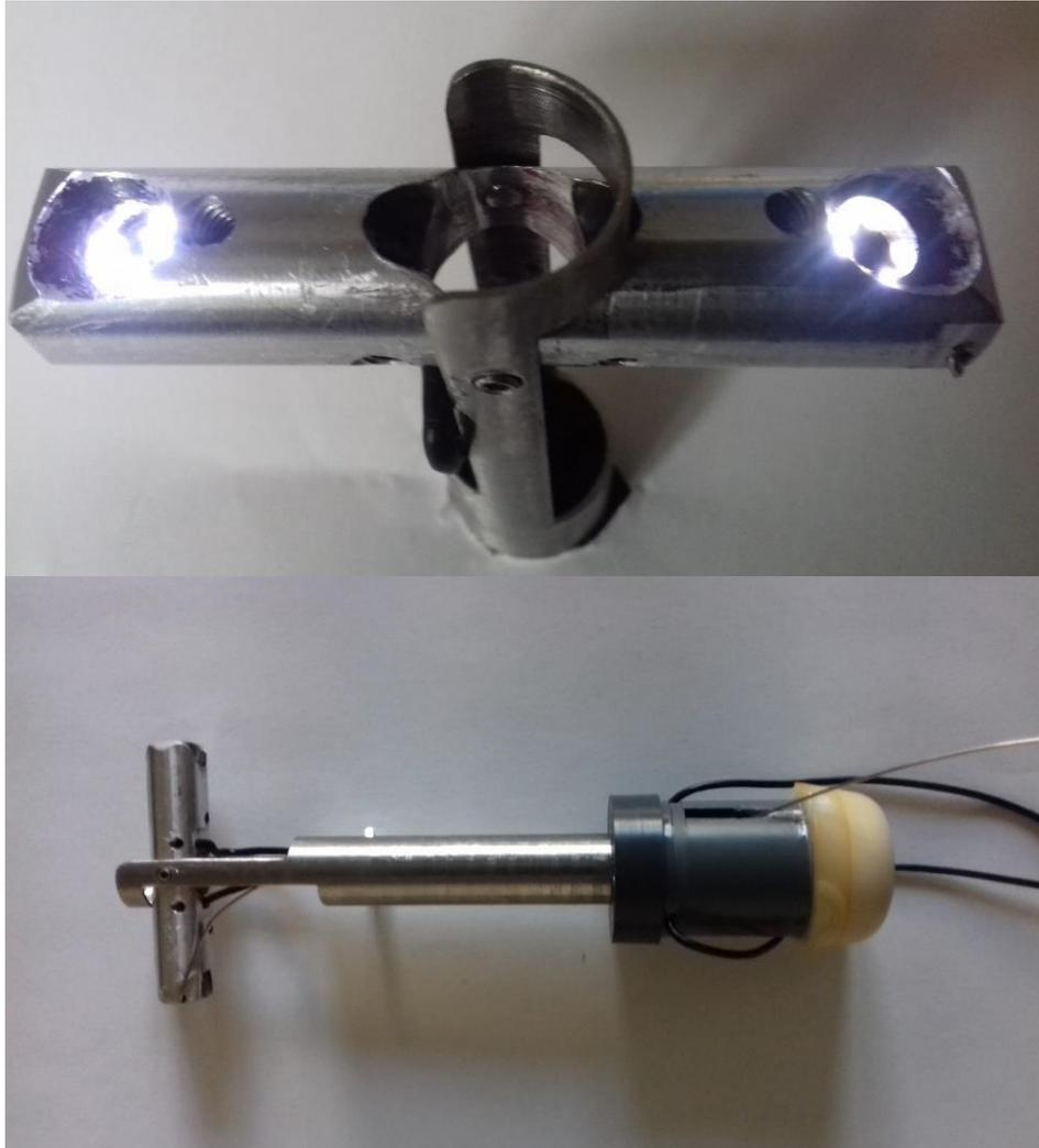
*Figure 39. Troisième prototype. L'ensemble est confectionné en métal intégrant des caméras auto éclairées.*
