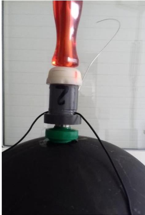
*Figure 68. Test d'étanchéité dans un ballon de basketball à travers lequel le SVG était inséré. Le ballon était gonflé à l'aide d'une pompe et supportait une pression de 30 mmHg*
