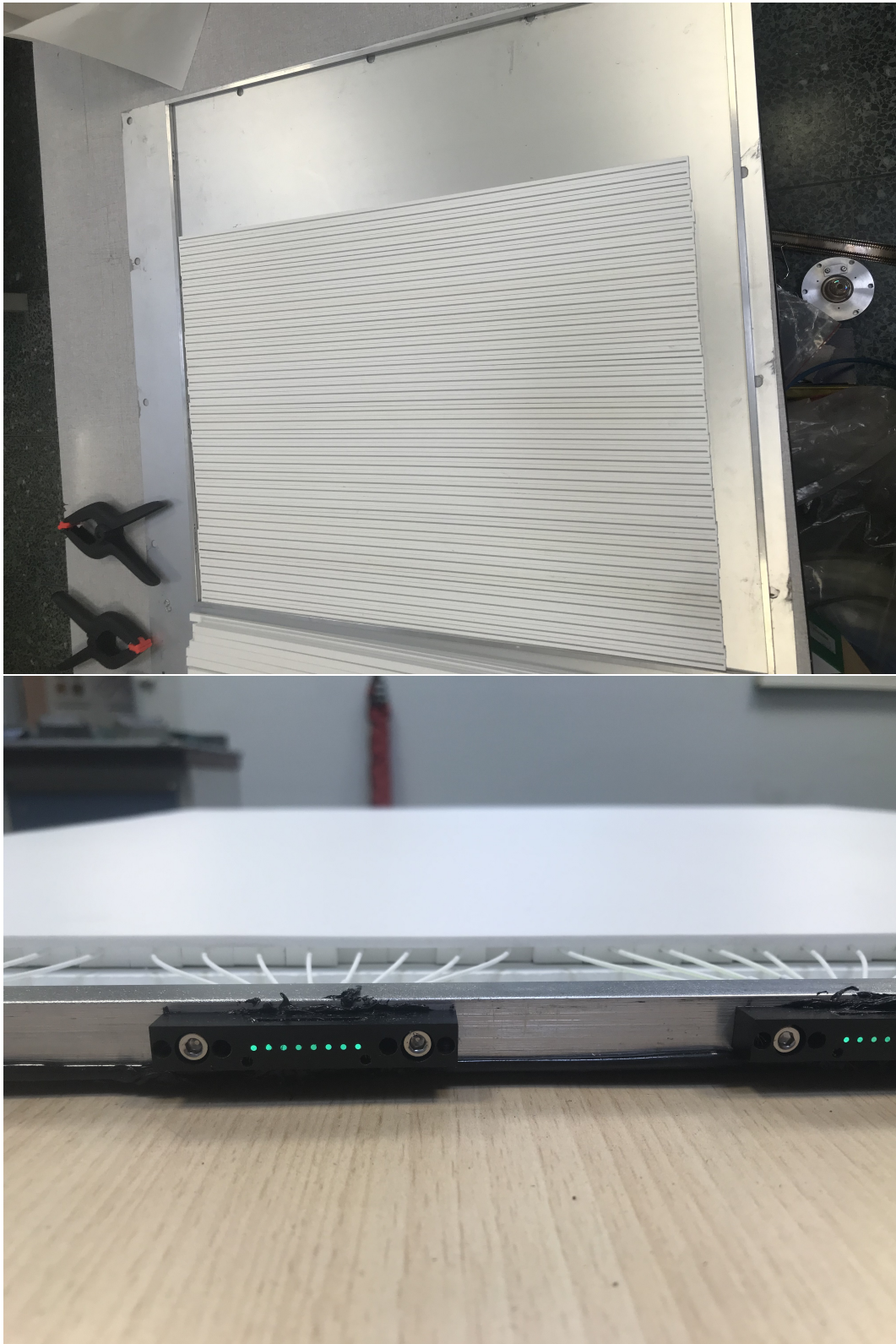
FIGURE 4.10 : Vues d'un détecteur à scintillateur en cours d'assemblage ( en haut ) et détail de sa connectique optique ( en bas ).
