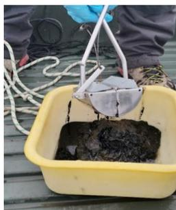
Figure 21 : échantillonnage des sédiments avec la benne Van Veen
