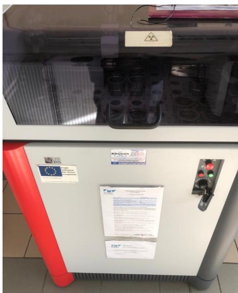
Fig. 53. X-ray fluorescence using S4 BRUKER.
