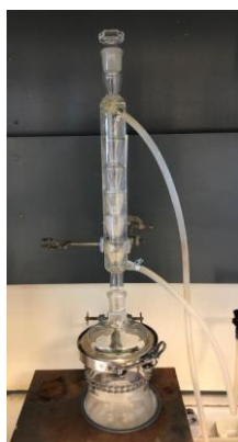
Fig. 56. Chapelle test setup.
