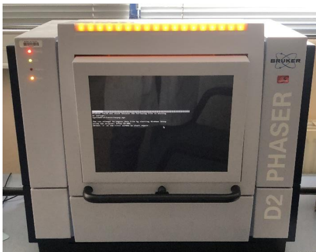
Fig. 54. X-ray diffraction using D2 Phaser BRUKER.
