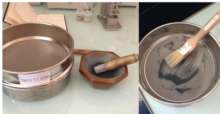
Figure 2-8 : Broyage des échantillons au mortier d'agate à un diamètre inférieur 80 \mu\text{m}
