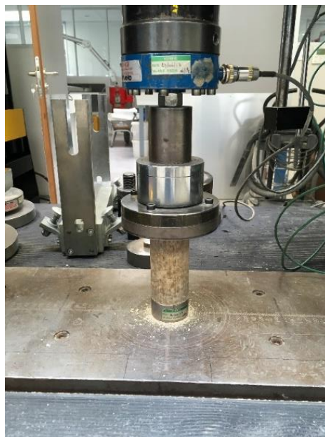
Figure 2-14 : Essai de résistance à la compression sur une éprouvette Ø5h10
