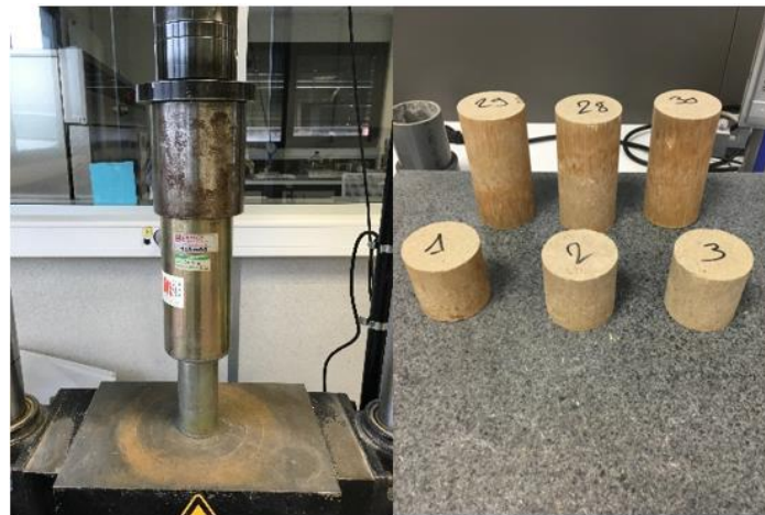
Figure 2-12 : Processus de démoulage d'éprouvette à la presse et triplicat des 2 types d'éprouvettes
