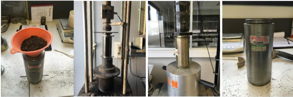
Figure 2-11 : Différentes étapes de confection des éprouvettes
