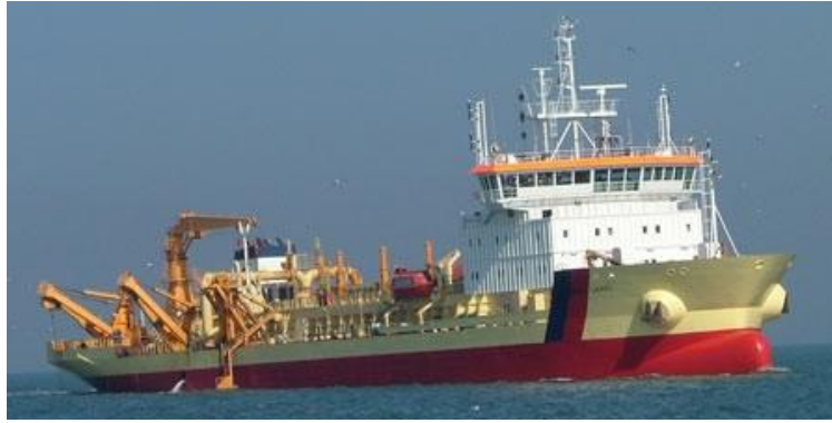
Figure 1-13 : Drague aspiratrice Daniel Laval (site web : dragages-ports.fr )
