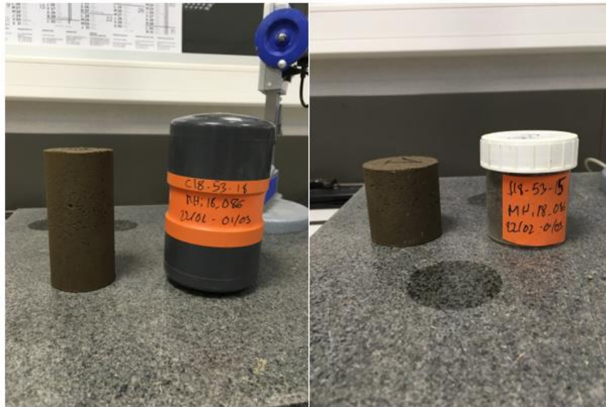
Figure 2-13 : Étuis étanches empêchant la dessiccation des éprouvettes (respectivement pour les éprouvettes Ø5h10 et Ø5h5 cm)
