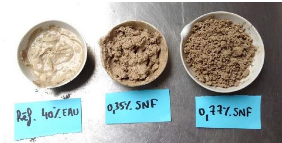
Figure 1-23 : Impact de l'utilisation de super absorbant SNF sur Btram
