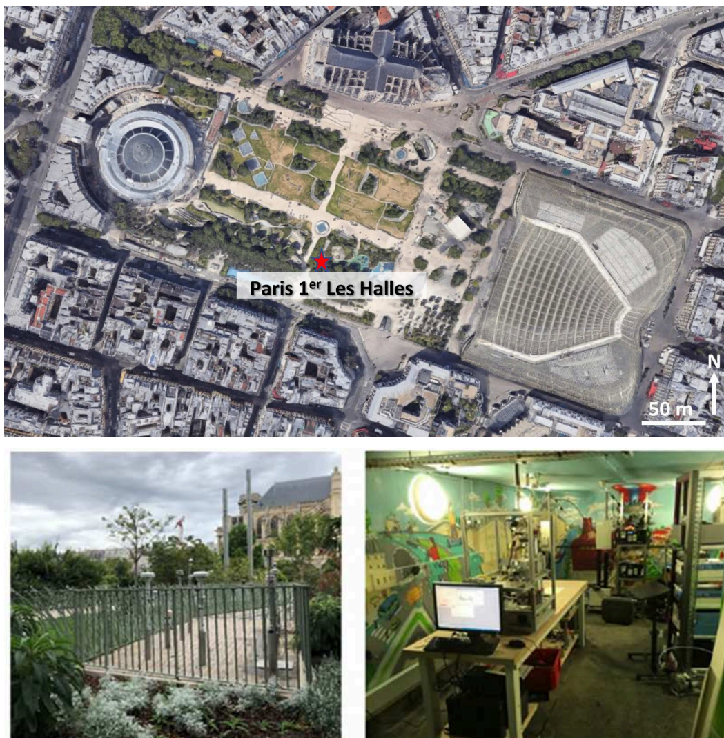
Figure II.5 : Carte précisant la localisation de la station Paris 1 er -Les Halles d’Airparif (haut) ; photographies (crédit : AirParif) des têtes de prélèvement (bas à gauche) et de l’intérieur de la station (bas à droite).
