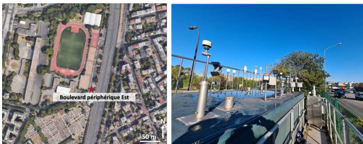
Figure II.6 : Carte précisant la localisation de la station BPEST (gauche) et photographie (crédit: AirParif) des têtes de prélèvement en bordure du périphérique (droite).
