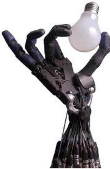
La forme et les matériaux (le caoutchouc mou par exemple) utilisés pour créer la main d'un robot, lui permettent d'attraper des objets.
