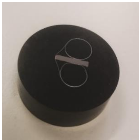
Figure 20 Echantillon dans une résine conductrice.
