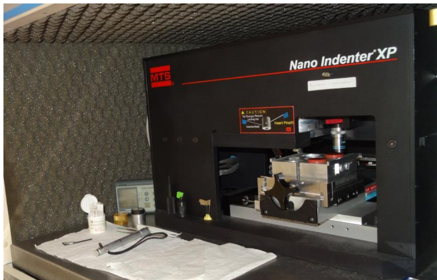
Figure 22 Dispositif utilisé pour la caractérisation par nanoindentation.
