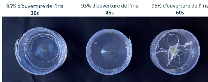
Figure 4.17 : Photopolymérisation d'une suspension PEGDA/NCC CERMAV 2.3 wt%
