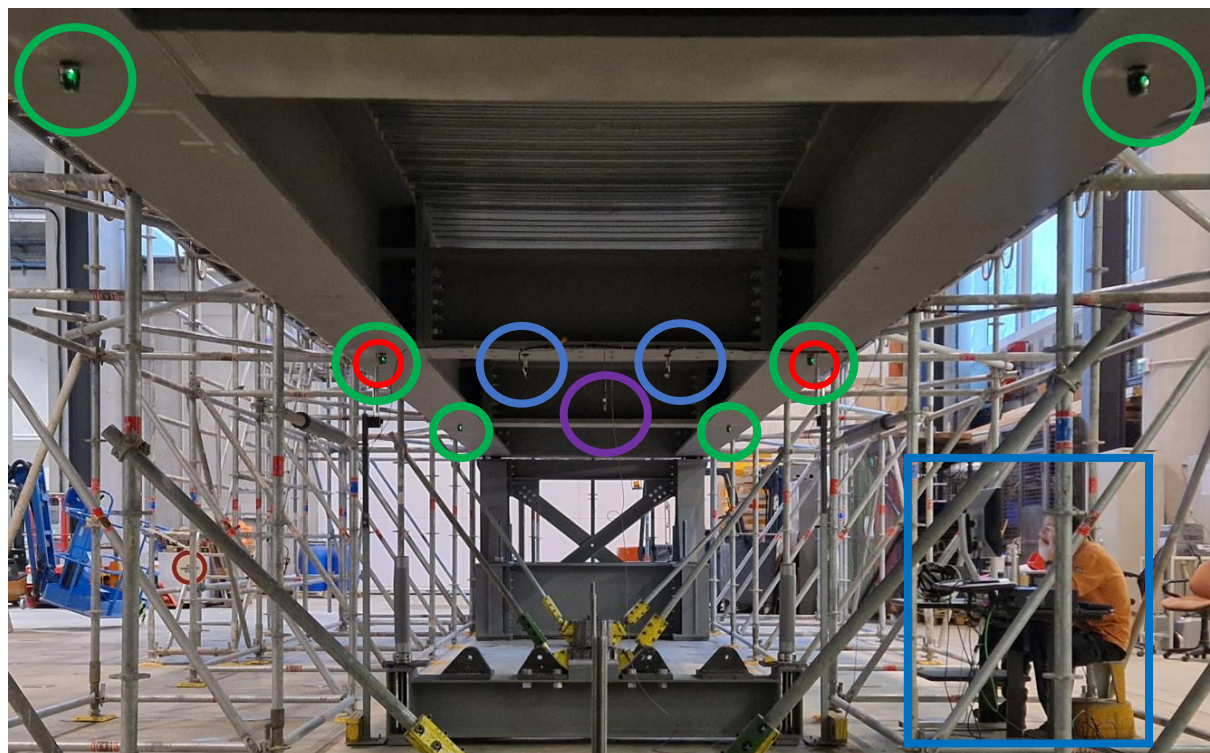
Figure 105 : Implantation générale des capteurs fixés sur la charpente
