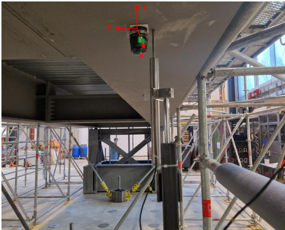
Figure 107 : Accéléromètre LORD au voisinage d'un capteur de déplacement LVDT sur pied
