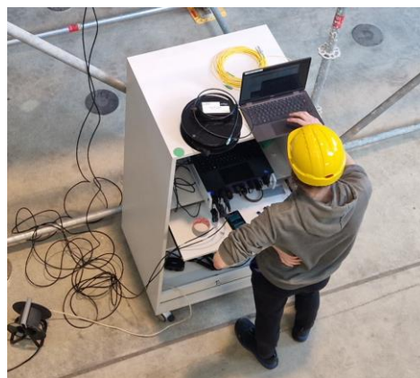
Figure 115 : Extrémité des fibres en attente après coulage et centrale d'acquisition de la fibre
