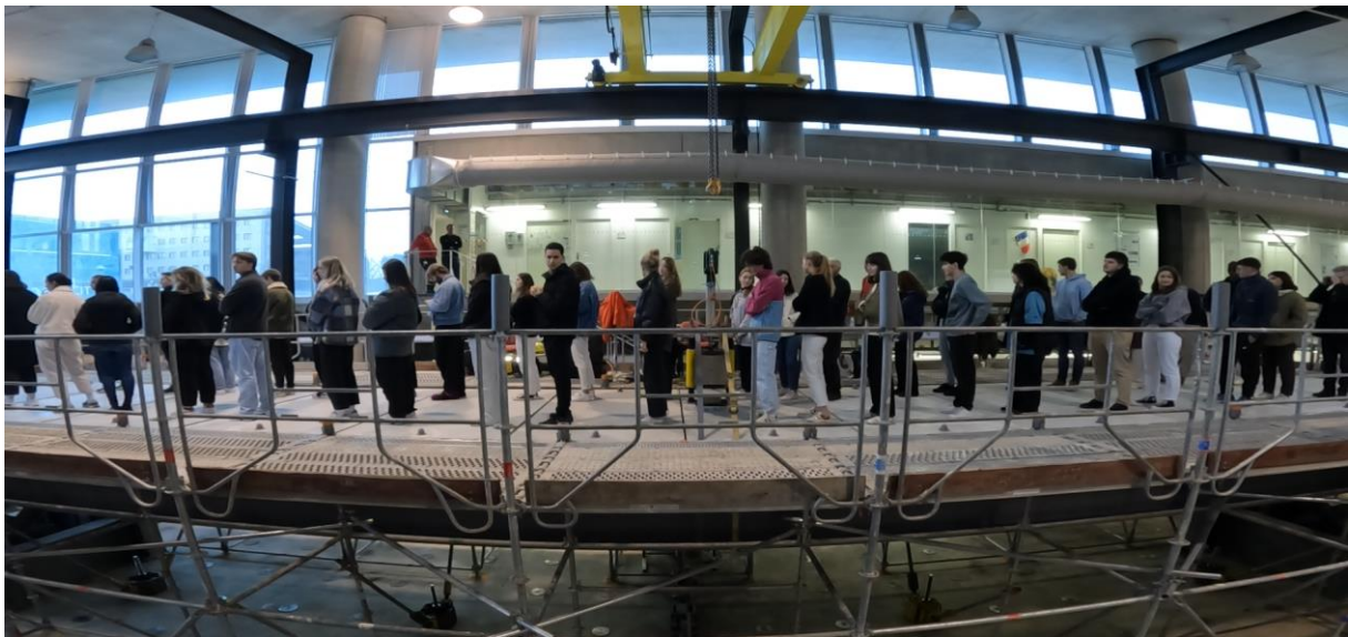
Figure 143 : Test avec excitateur et 40 individus statiques (Test 3)
