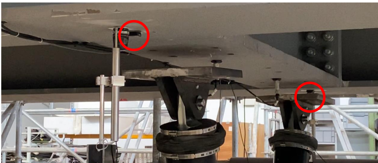
Figure 119 : Emplacement des capteurs de synchronisation pendant le test H2 du 13/04/2023
