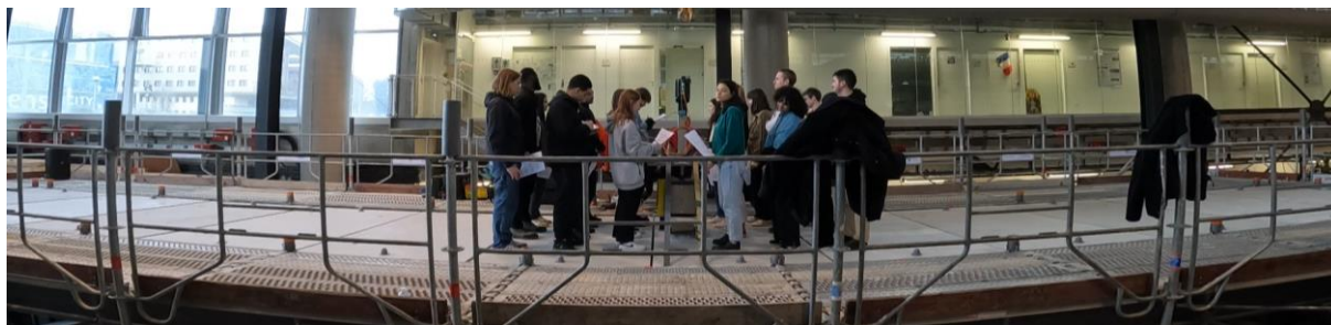
Figure 150 : Test avec exciteur avec 18 individus statiques (Test 5)
