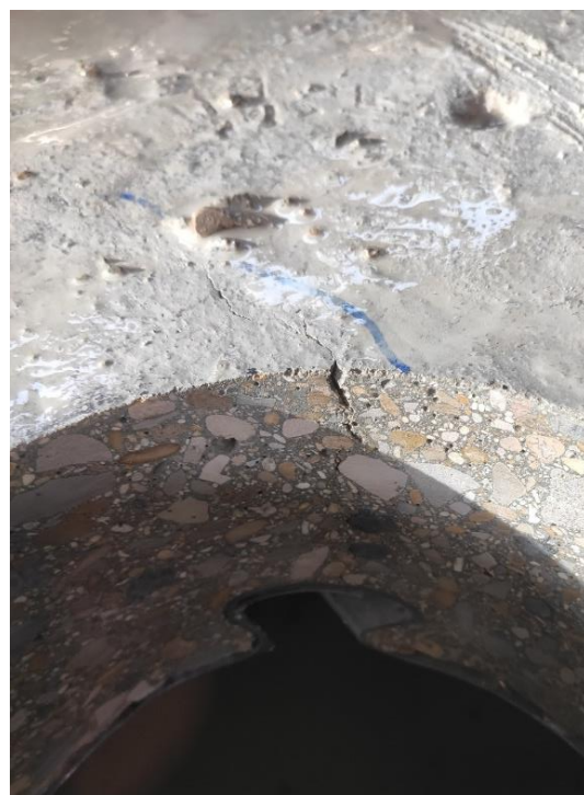
Figure 252 : Fissure principale due à la flexion et fissures de retrait
