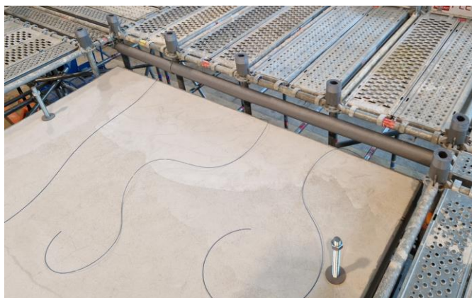
Figure 115 : Extrémité des fibres en attente après coulage et centrale d'acquisition de la fibre
