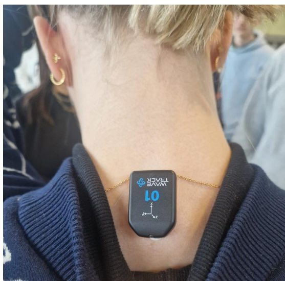
Figure 118 : Centrale inertielle fixée par adhésif et centrale d'acquisition COMETA
