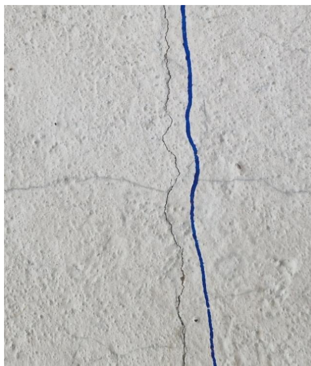
Figure 252 : Fissure principale due à la flexion et fissures de retrait
