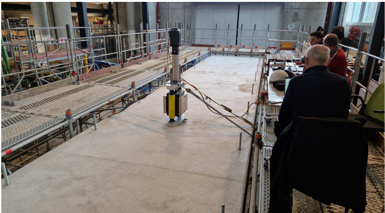
Figure 94 : Essais avec excitateur mécanique de l'ULiège le 10/03/2023
