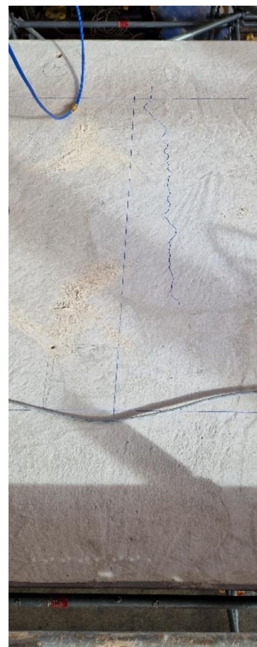
Figure 251 : Fissures centrales entre dalles 6 et 7 et fissures est entre dalles 3 et 4
