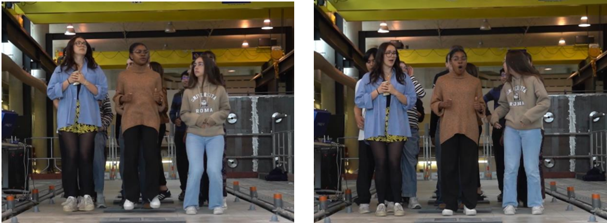
Figure 191 : Pendant et après le saut à 16 personnes sans amortisseurs (CAR SA) a_{pic} = 3,4m/s^2
