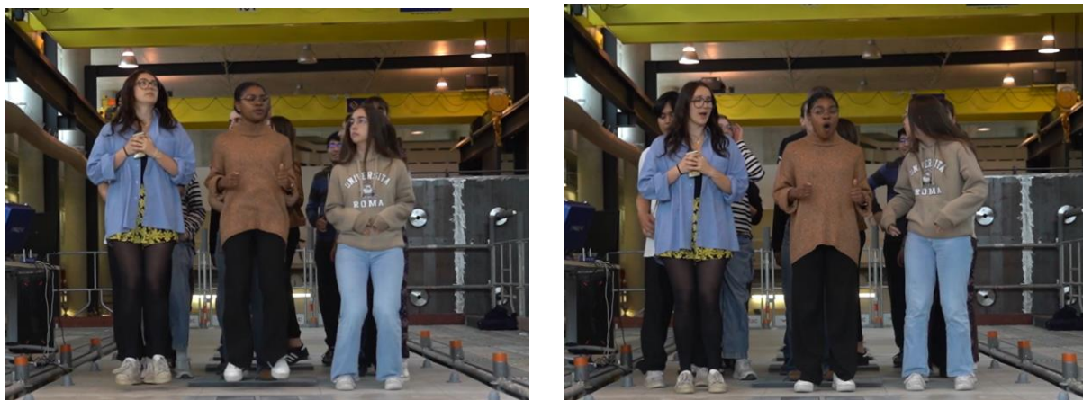
Figure 231 : Pendant et après le saut à 16 personnes sans amortisseurs (CAR SA) a_{pic} = 3,4 \text{ m/s}^2
