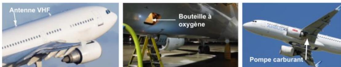
Figure 69 : Image de gauche : Antenne VHF, Image du milieu : Bouteille à oxygène et image de droite : Pompe à carburant.
