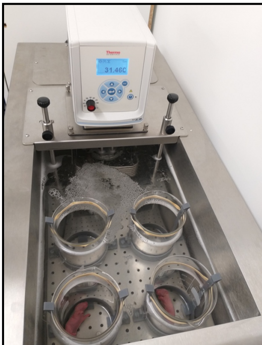
Figure 19 : Bain-marie servant au contrôle des températures post-HIN.
