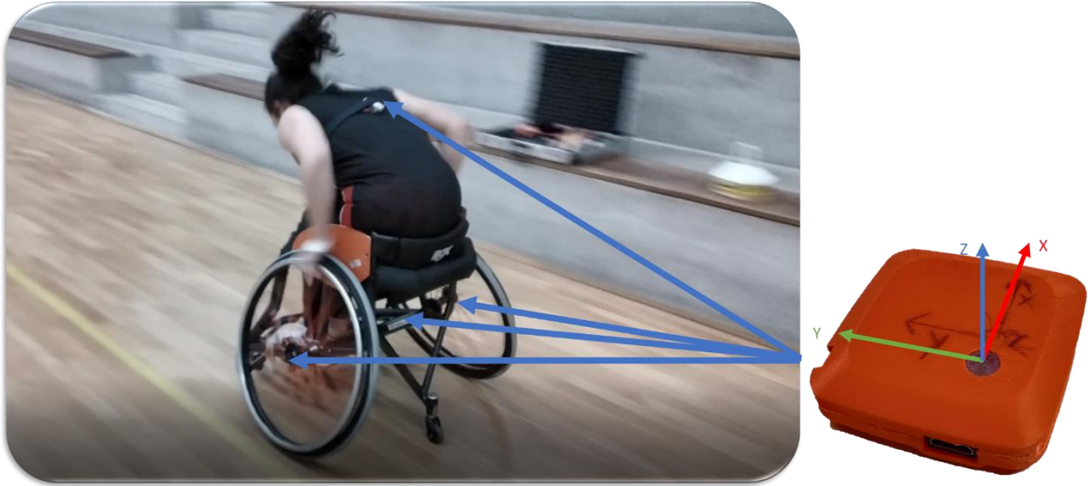
Figure 18 : À gauche, photographie d'une joueuse de basketball fauteuil (classification 4.5) lors d'un sprint en ligne droite. À droite, représentation d'une centrale inertielle (IMU ; atounovation) utilisée lors des tests en milieu écologique.
