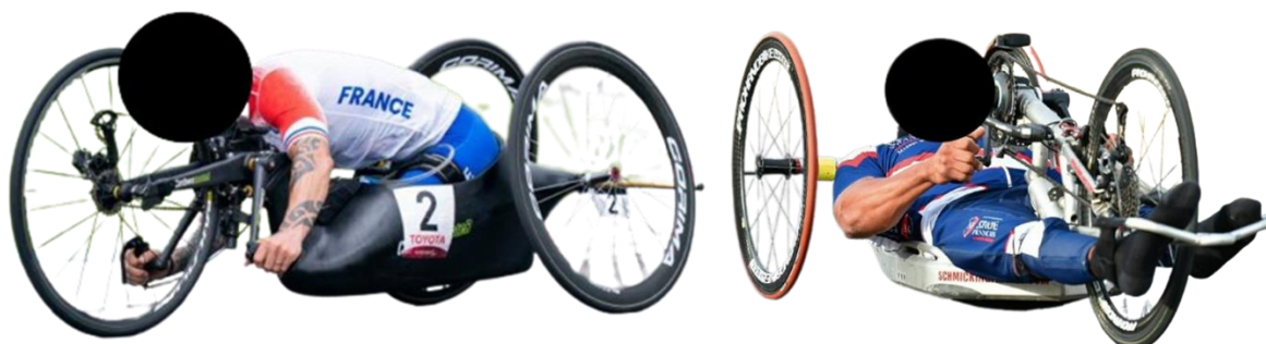
Figure 2 : Photos de deux types de handbike. À gauche le type Arm Trunk Power (ATP) avec un cycliste classé H5 et à droite, le type Arm Power (AP) avec un cycliste classé H3.
