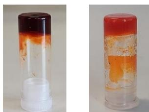
Figure 77 - Test du tube renversé sur les gels formés - De gauche à droite : **P1a** dans toluène ( $C = 20 \text{ mg}\cdot\text{mL}^{-1}$ ), **P1b** dans 1,1,2,2-tétrachloroéthane ( $C = 12 \text{ mg}\cdot\text{mL}^{-1}$ )
