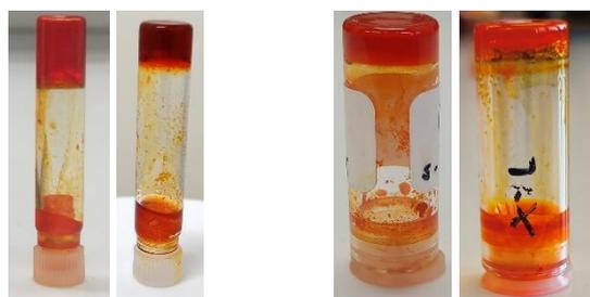
Figure 29 - Test du tube renversé sur les gels formés - De droite à gauche : 3a dans Toluène et Xylène, 3b dans Toluène et Xylène (concentration = 20 mg.mL<sup>-1</sup>)
