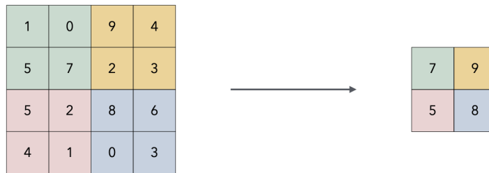
Figure 4.3. Max pooling avec un filtre 2 \times 2
