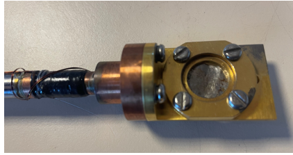
FIGURE II.17 – Porte-échantillon utilisé pour les mesures Mössbauer.
