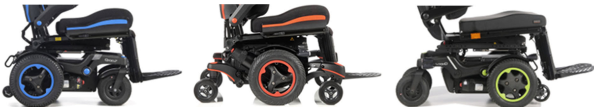
Figure 11. Les différentes motorisations de FRE : propulsion, traction médiane ou 6 roues, traction (de gauche à droite)
