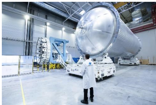
Figure 1-3 : Photo d'un réservoir cryogénique d'hydrogène liquéfié à -253^\circ\text{C} d'Ariane Group [4].
