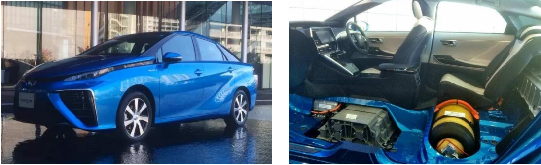
Figure 1-2 : Photos du premier véhicule à hydrogène doté d'un réservoir stockant de l'hydrogène à l'état gazeux en 2014 [3].
