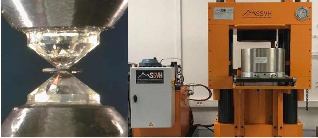
Figure 16: a) Cellule enclume diamant, avec un joint contenant l'échantillon au centre © Sébastien Merkel et b) Presse multi enclume de l'institut Chevreul (Université Lille 1)
