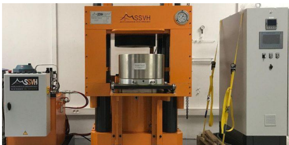
Figure 4: Image du système de presse et de lecture de température utilisé © Institut Chevreul
