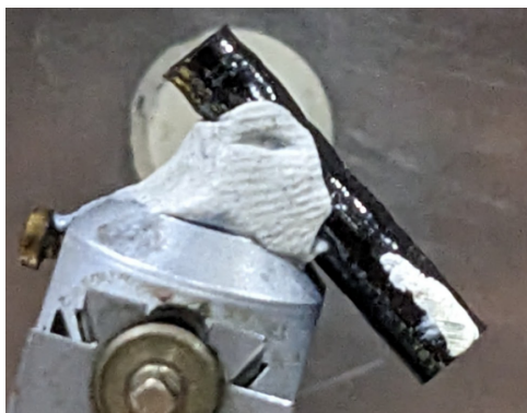
FIGURE 5.15 – Monocristal de \text{Tb}_2\text{Ti}_2\text{O}_7 , orienté dans le plan (H, H, 0) - (0, 0, L) , utilisé durant notre expérience sur THALES.
