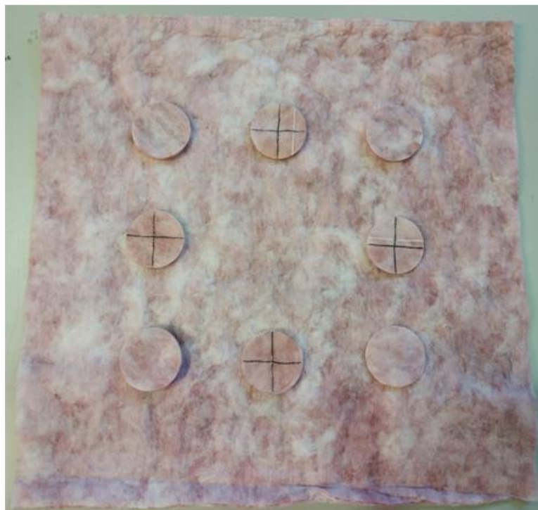
Figure 2-10 : Photographie du filtre avec les coupons avant les tests de perméabilité
