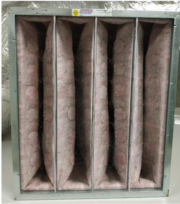
Figure 4-6 : Photographies du filtre avec les coupons après les prélèvements de mars 2021.
