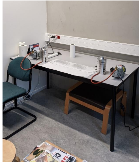
Figure 4-2 : Photographies de la salle du rez-de-jardin du bâtiment J avec les impacteurs Andersen installés.
