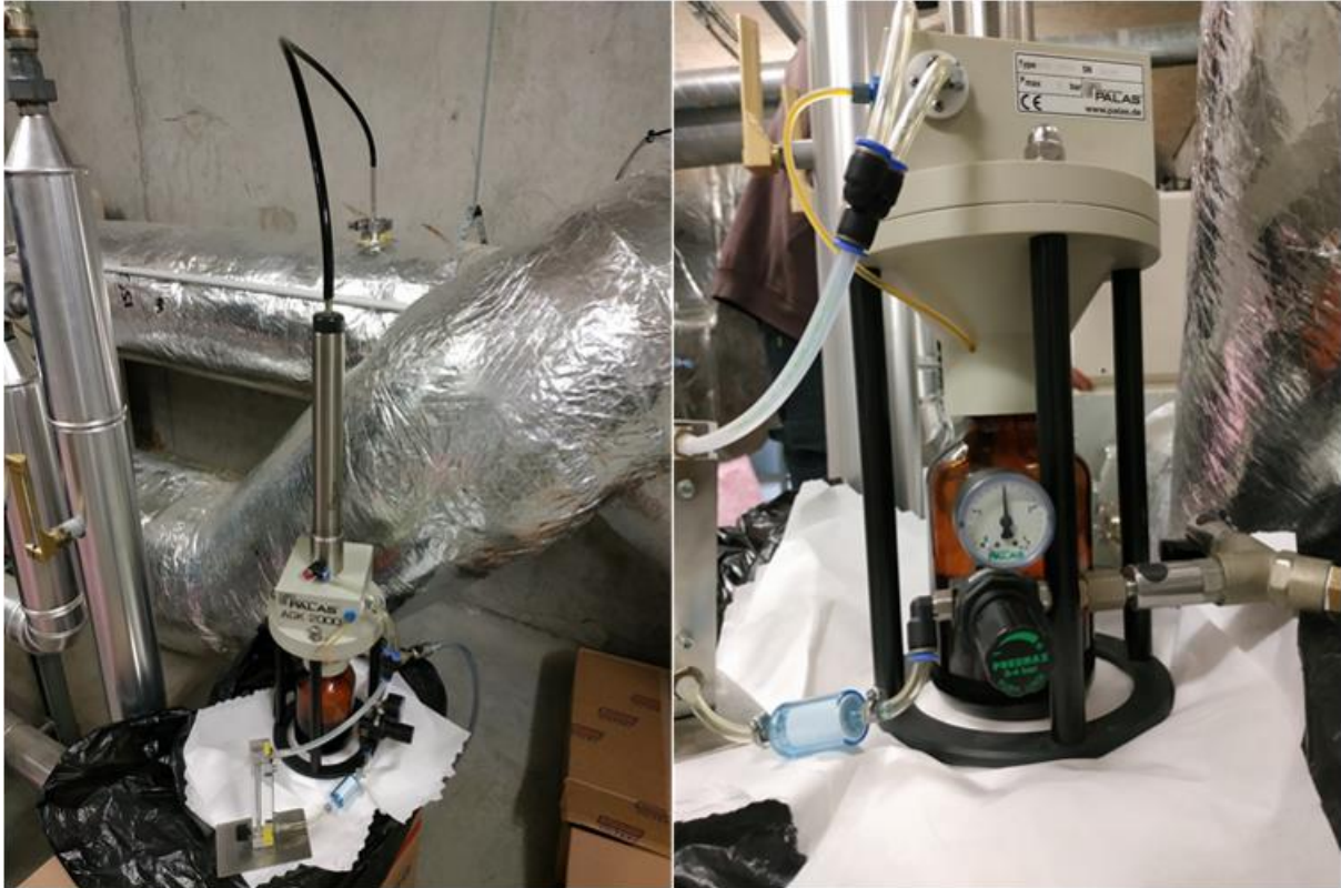
Figure 2-12 : Photographie de l'AGK2000 pendant la génération de fluorescéine en amont du compartiment d'extraction d'air
