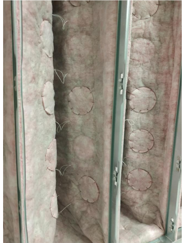
Figure 4-6 : Photographies du filtre avec les coupons après les prélèvements de mars 2021.
