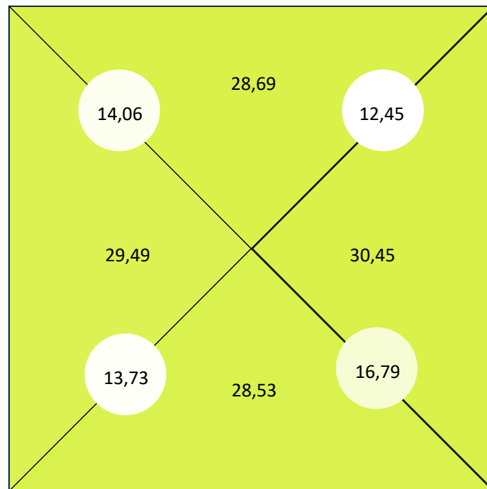
Figure 2-11 : Schéma représentant la masse de fluorescéine déposée sur le média filtrant et sur les coupon (en \mu\text{g}/\text{cm}^2 )
