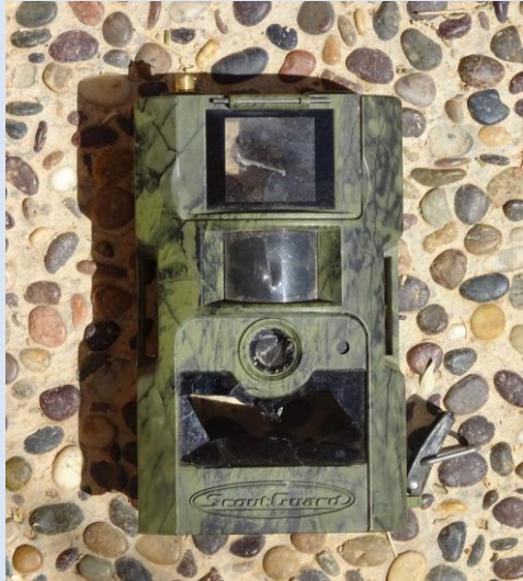
Figure 15. PP retrouvé détruit (lentille brisée, écran et capteur infrarouge transpercés) lors de sa récupération sur un nid.
