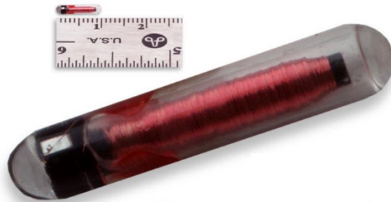
Figure 16. Transpondeur utilisé pour le marquage des outardes Houbara depuis 2006 (échelle supérieure de la règle en cm).
