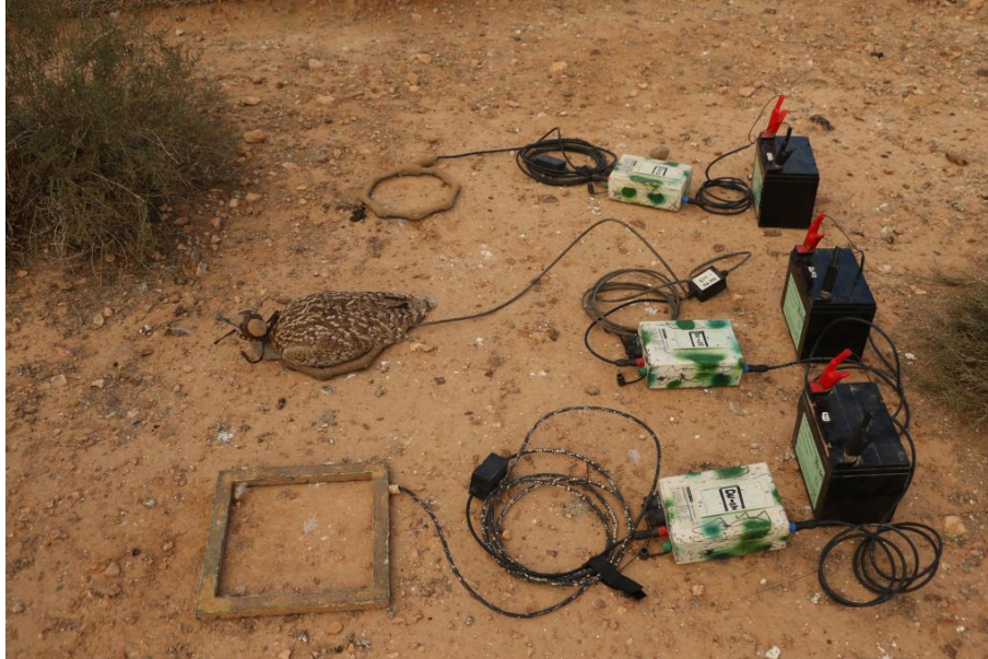
Figure 18. Phase de test des lecteurs avec antenne carrée et octogonale en captivité sur des outardes Houbara d'élevages.
