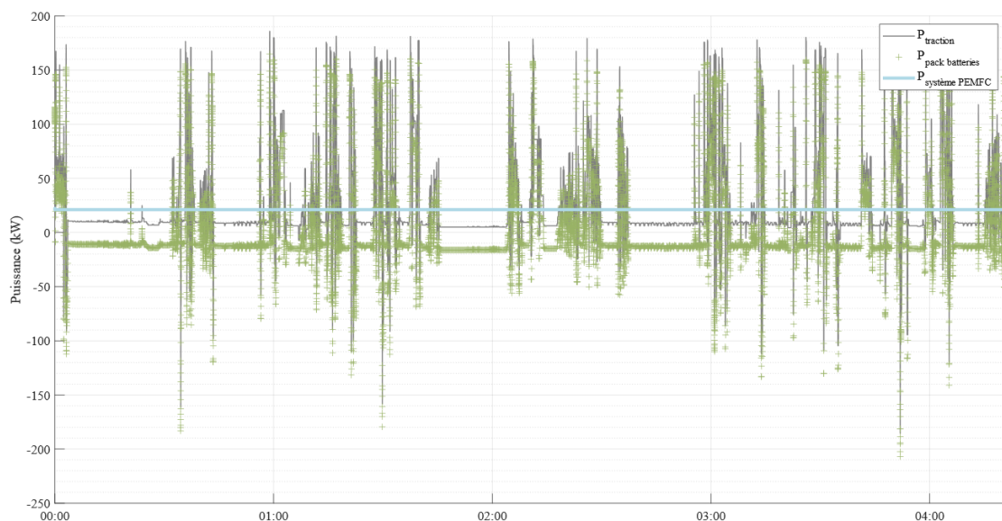
Figure 4.16 – Évolution de la demande en puissance et réponse en puissance du pack NMCb et du système PEMFC pour le cycle n°4, Stratégie n°1
