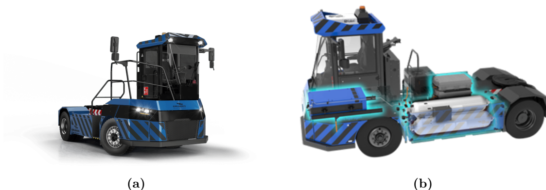
Figure 1.8 – APM 75T Hydrogène GAUSSIN : (a) Présentation du véhicule (b) Présentation de la disposition des réservoirs hydrogène et de la pile à hydrogène au sein du véhicule
