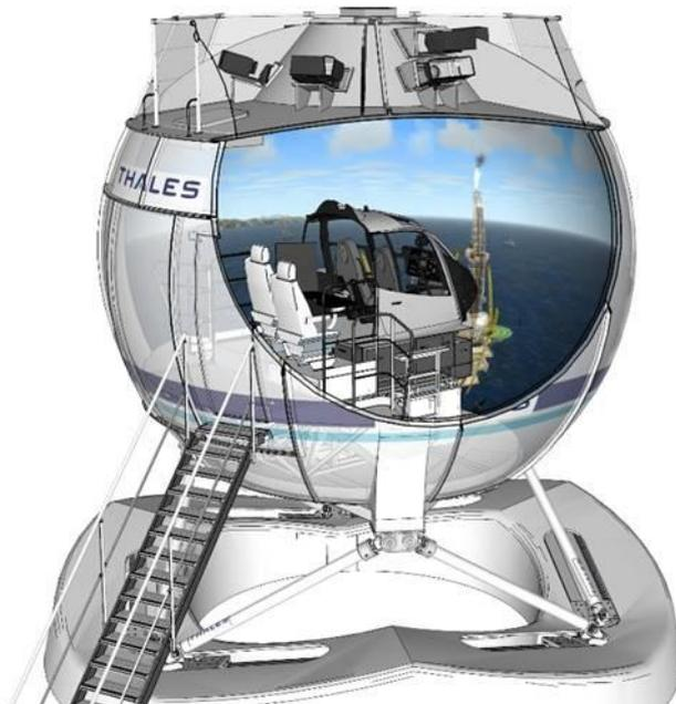
*Figure 5 : Schéma du simulateur utilisé pour l'expérimentation IKKY. La cabine utilisée était celle d'un Eurocopter 135, le pilote était assis à droite. Le dôme prenait l'intégralité du champ visuel et il était monté sur un système de vérins à six degrés de liberté.*
