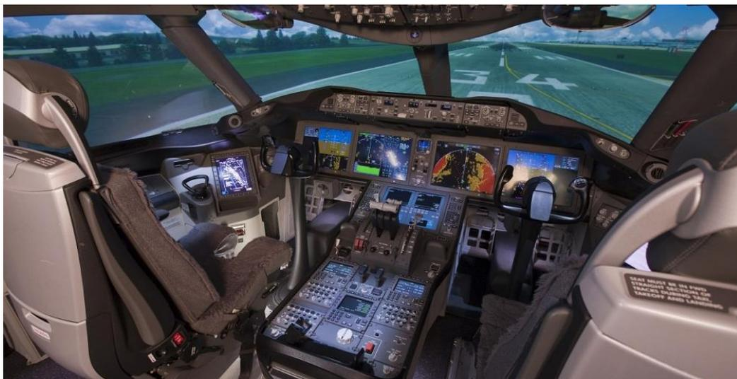
*Figure 4 : Photo d'un cockpit beaucoup plus récent. Les écrans sont beaucoup plus nombreux et les touches actionnables situées partout autour du pilote (devant, entre les pilotes, au-dessus de leurs têtes, etc.).*
