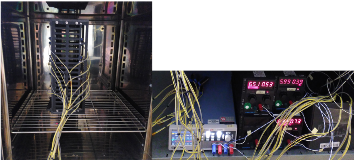
FIGURE 3.16 – Essais accélérés des inductances ferrite multicouches - Choc thermique.
