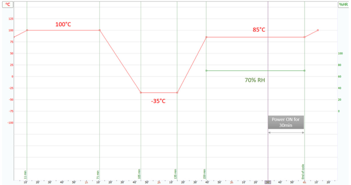
FIGURE 3.6 – Profil 1 de cyclage thermique pour les résistances de tailles 0201 et 01005.
