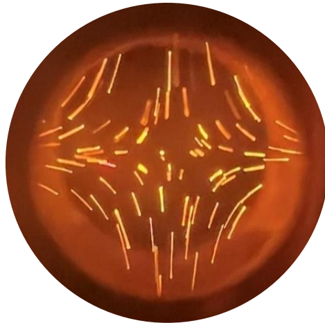
Figure III-10 — Photographie prise par l'un des hublots de la chambre montrant des particules chargées dans le champ électrique du lévitateur. Les particules sont illuminées par une source de lumière disposée devant l'un des hublots situés sur l'axe perpendiculaire à l'axe de visée utilisé pour la photographie.
