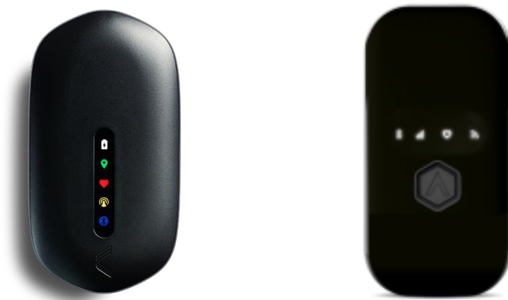
Figure 9 : Deux des unités GPS les plus utilisés actuellement dans le football professionnel (clubs et fédérations) avec une fréquence d'échantillonnage à 10 Hz et la double constellation (GPS + GNSS). A gauche, le Vector S7 de Catapult et à droite, le Apex Pro Series Pod de STATSport.
