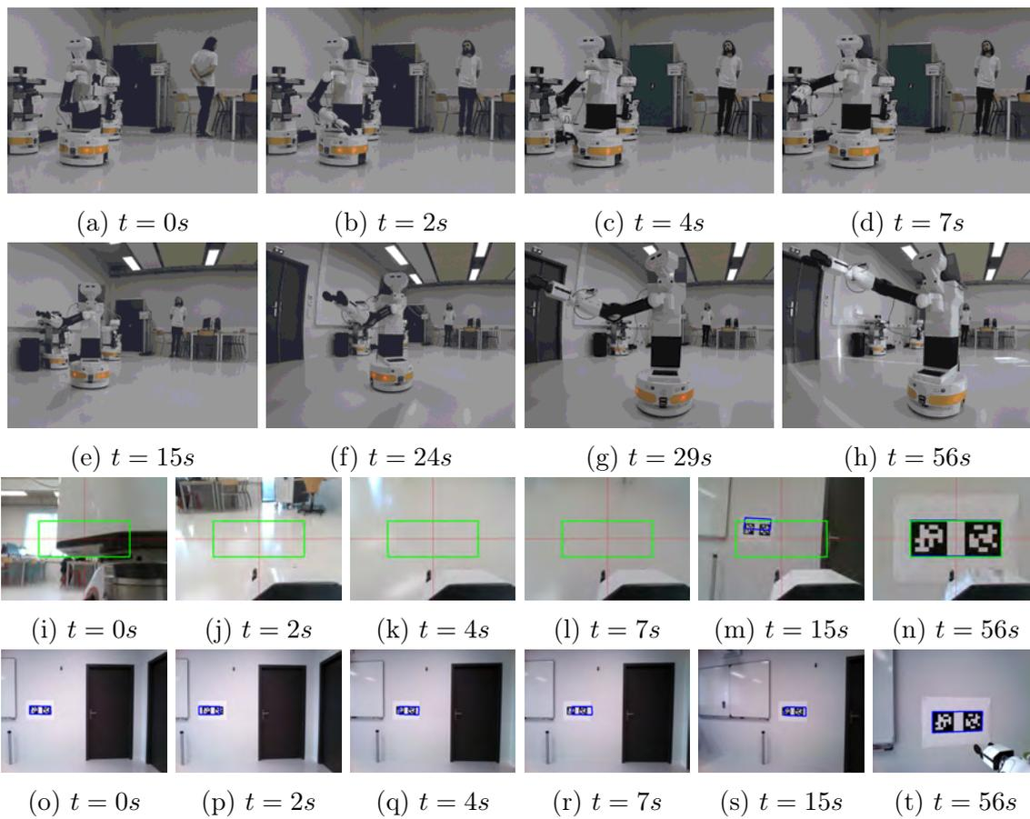
FIGURE 4.33 – Trajectoire du robot (a)-(h), informations de la caméra de l'organe terminal (i)-(n) et informations de la caméra de la tête (o)-(t)
