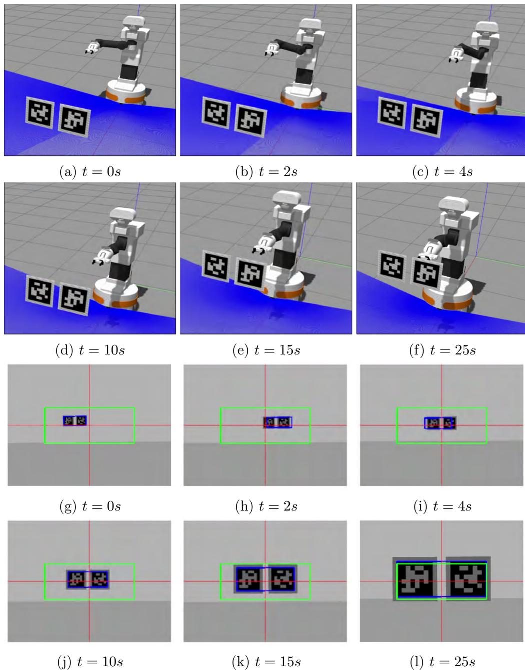
FIGURE 3.6 – Trajectoires du robot et des images obtenues
