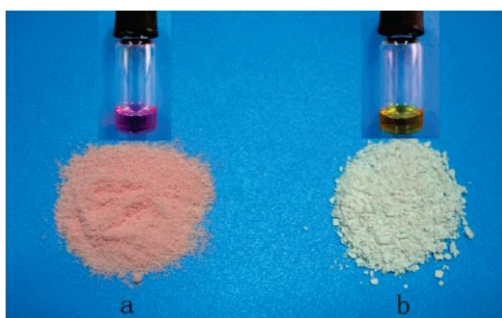
Figure 93. Structure du polymère PMMA et aspect (en solution ou précipité) avant (a) ou après (b) chauffage à 120 °C pendant 30 heures
