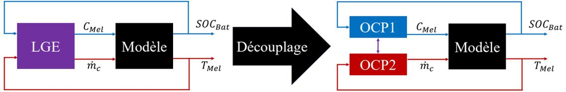
FIGURE 4.12 – Division du problème initial à deux états et deux commandes en deux sous-problèmes de un état et une commande liés par leurs interactions.
