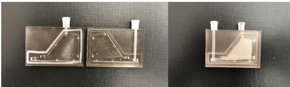
Figure 46 : Moule bivalve de première génération avec tunnel d'injection décliné unique et évent positionné au point le plus haut.
