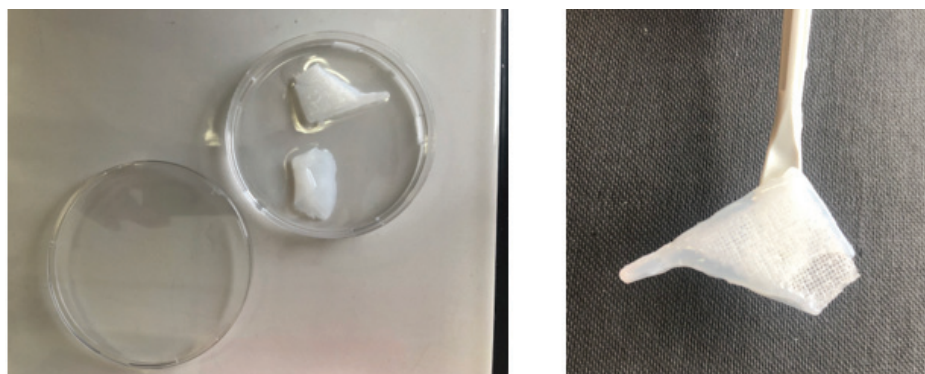
Figure 47 : Résultats des premières injections avec la fibrine seule : Arrachement partiel du gel au démoulage et bulles d'air captives pendant l'injection, aboutissant à des zones du scaffold non couvertes par le gel.
