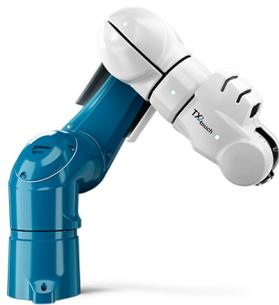
(a) Robot collaboratif Stäubli. La partie blanche du robot est une peau sensible entraînant l'arrêt en cas de contact.
