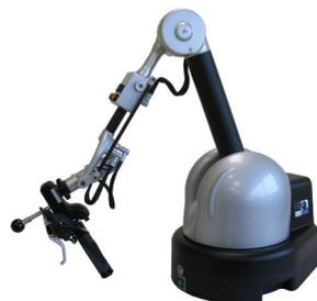
(b) Dispositif haptique Virtuose 6D V4 de Haption.
