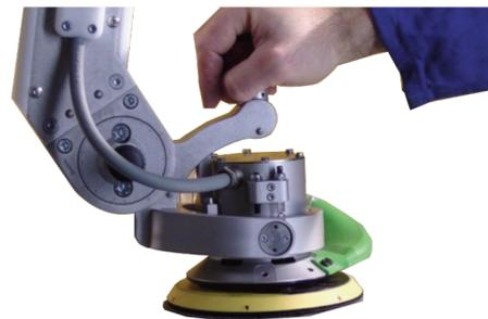
(b) Poignée permettant de contrôler la position de l'effecteur du robot Isybot.
