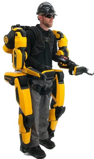
Figure 1.28 – **Exosquelette à augmentation Sarcos.** L'exosquelette est contrôlé en admittance à l'aide de capteurs de forces intégrés dans les poignées. L'interaction se fait à l'aide de crochets (ou à l'aide de tout effecteur monté à leur place), l'utilisateur n'interagit donc pas directement avec son environnement.
