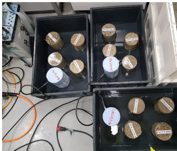
Fig. 6.3. Epreuves instrumentées M3 ( \varnothing 11 \times 18 cm avec de la résine claire) et non instrumentées C8 et C9 ( \varnothing 11 \times 11 cm) en diffusion.
