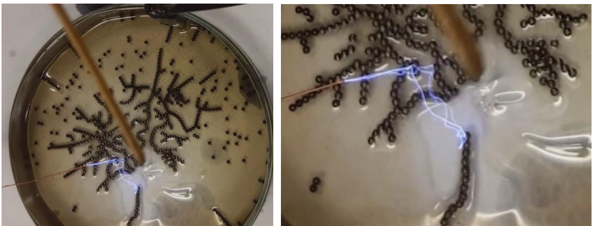
Fig. 72 t=2m33s . À gauche nous avons l'ensemble du système, et à droite nous avons une mise en détail qui nous fait mieux apprécier la foudre entre l'électrode de source et l'extrémité du bras que nous aidons à grandir. Notons que cela arrive après que nous avons violenté le système, en coupant toutes les liaisons qui reliaient le grand réseau au bord que fait puits.
