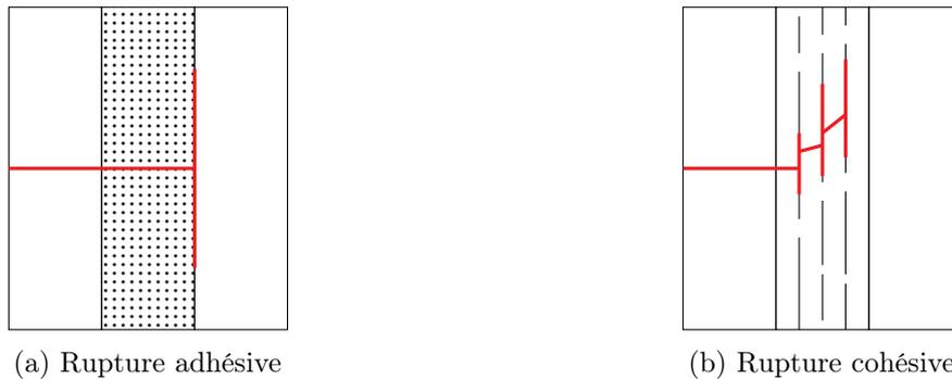
FIGURE 1.6 – Mécanismes de déviation des fissures dans les systèmes interfaciaux.
