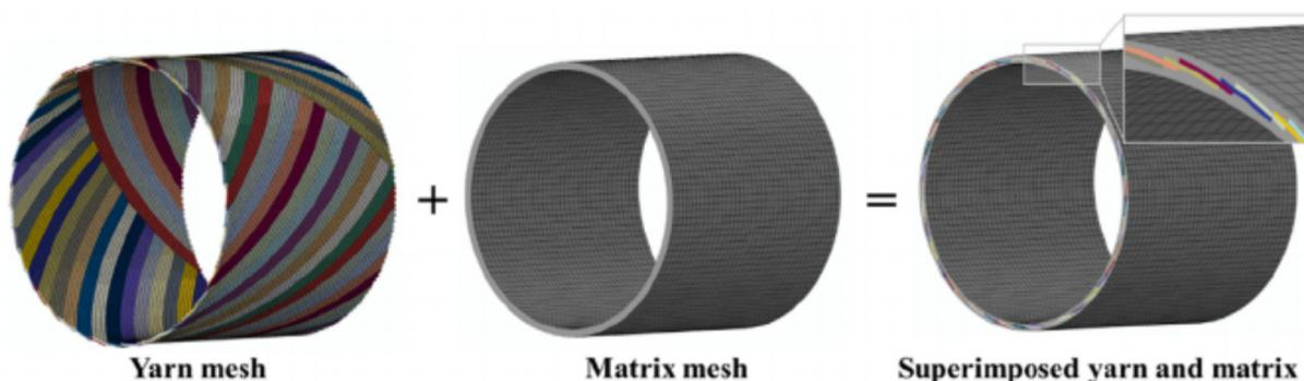
FIGURE 4.21 – Exemple de maillages superposés dans un tube SiC/SiC tissé, par [Tan21].
