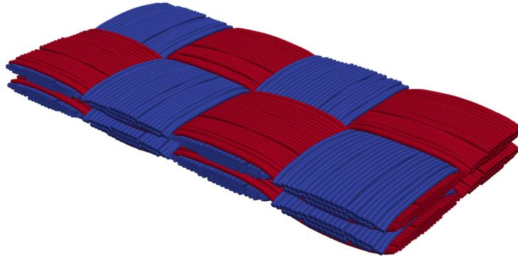
FIGURE 5.20 – Exemple de tissage discrétisé et relaxé.
