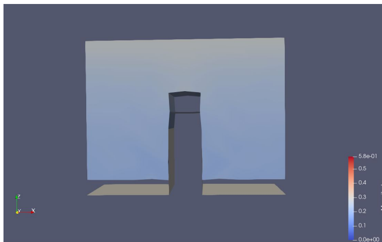
FIGURE 4.37 – Norme du déplacement (m) à t = 0.0150 s obtenu avec MEF++ avec le champ de normales introduit en figure 4.33.
