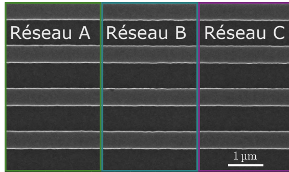
FIGURE 2.26 – Images au microscope électronique à balayage (MEB) des trois réseaux A , B & C de l'échantillon, vue du dessus, avec des périodes \Lambda et des facteurs de remplissage FF identiques.
