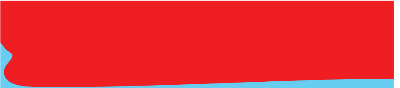
FIGURE 4.16 – Capture d'écran du dimple pour un impact à St = 2.67 * 10^{-4} . Nous observons un étalement du dimple sur une grande distance relative à la taille du rayon. L'interface de la goutte n'a plus une forme parabolique.
