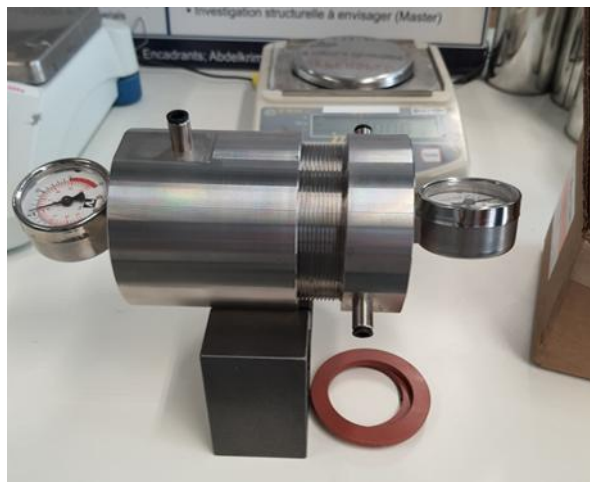
Figure 2-13 : Schéma du dispositif expérimental pour les mesures de diffusion du CO 2 (a) et photo de la cellule de diffusion (b).
