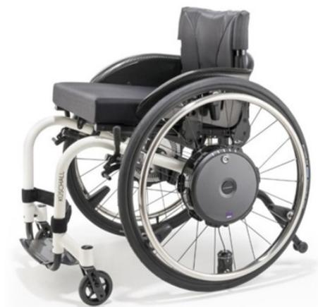
FIGURE 1.13 – Fauteuil roulant avec assistance électrique Alber E-motion.
