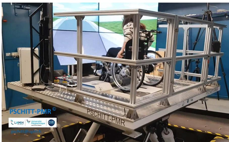
FIGURE 1.21 – Simulateur PSCHITT-PMR conçu aux LAMIH.
