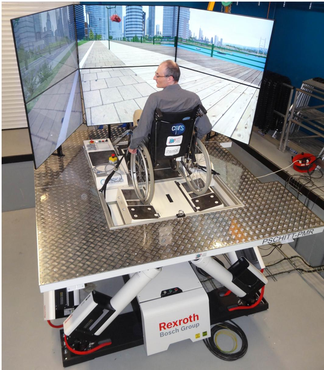
FIGURE 1 – Plateforme de Simulation Collaborative Hybride, Intermodale en Transport Terrestre-Personne à Mobilité Réduite (PSCHITT-PMR).
