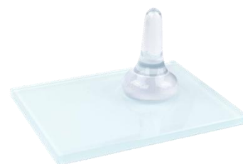
Figure 28 : Molette et plaque de verre. (source : Kremer Pigmente)
