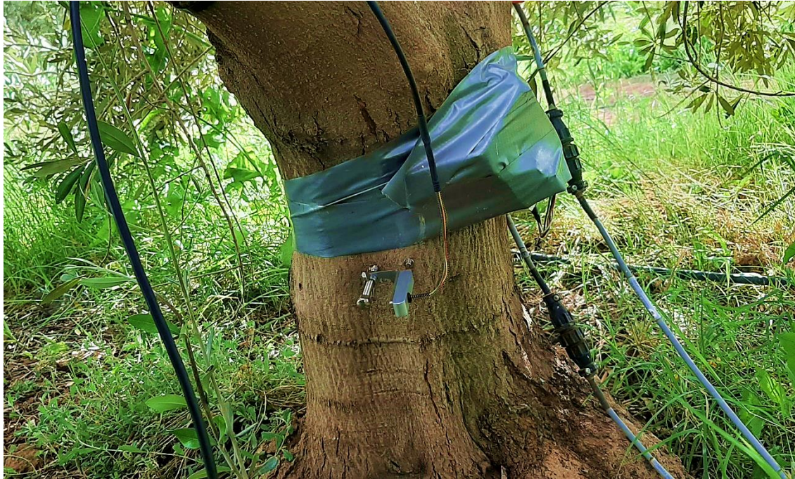
Figure II. 6 : Photos illustrant la mise de l'un des dendromètres sur le tronc d'un arbre d'olivier proximité d'une sonde TDP-50
