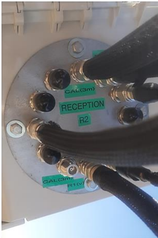
Figure II. 13 : Photos des connexions des câbles d'antennes-coffret-duplexeurs : A) illustration en 3D de l'ensemble des liaisons entre VNA, duplexeurs et connecteurs coaxiaux du coffret. B) et C) photos des connecteurs coaxiaux et le câblage reliant les d'antennes aux duplexeurs.
