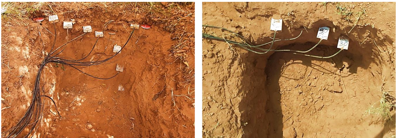
Figure II. 9 : Photos de la mise en place des sondes TDR (capteurs blancs carrés) et des plaquettes de flux (capteurs rouges ronds) dans deux fosses situées près de la station d'Eddy-covariance. Photo à gauche montre la fosse se trouvant au pied d'un tronc d'arbre d'olivier se composant de deux sondes à 5 cm dont une à gauche et l'autre à droite du tronc, et les autres profondeurs 10 cm, 15 cm, 20 cm, 30 cm, 50 cm et 80 cm sous forme d'escalier. La photo à droite montre la fosse entre rang avec les sondes TDR de 10 cm, 20 cm et 30 cm, la sonde de 5 cm ne figure pas sur la photo.
