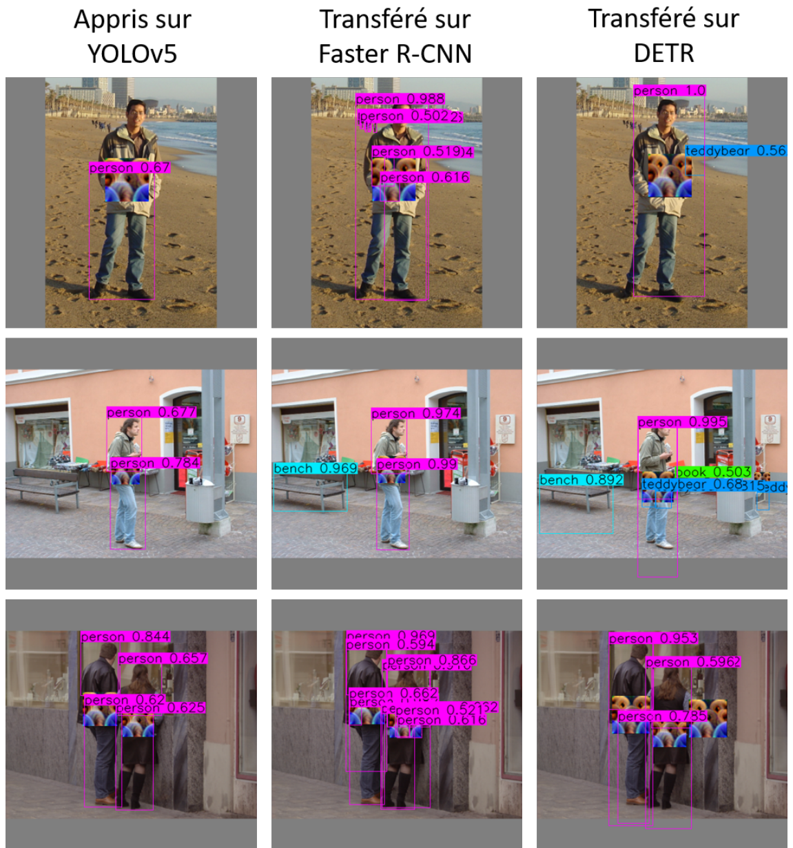
Figure D.3: Exemples d'attaque de cape invisible en white-box (conçue sur YOLOv5 et appliquée à celui-ci) et de transfert en black-box. Le patch est conçu sur YOLOv5 et provient du travail de Huang et al. (2023) . Les patches sont conçus pour empêcher la détection des personnes.
