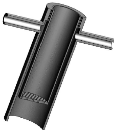
FIGURE A.6 – Dessin de l'utilisation d'un joint labyrinthe à jeu rallongé pour diriger les jets entrants vers le bas dans la maquette.
