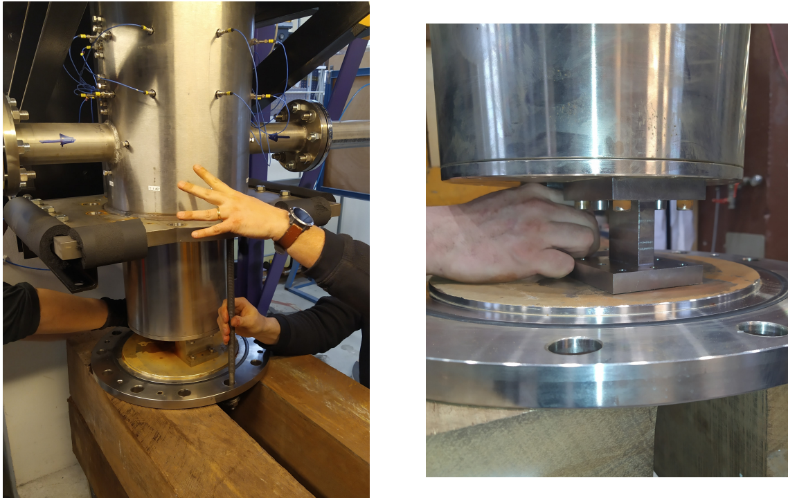
FIGURE 7.1 – Photos de la procédure de changement de configuration de CORVET. Gauche : descente de l'ensemble interne de CORVET. Droite : remplacement des supports de panier interne.
