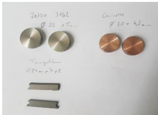
Figure IV-23 : échantillons représentatifs de l'émittance-mètre (inox 316L, cuivre et tungstène).
