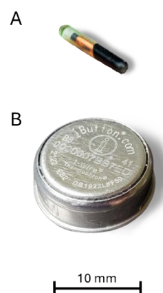
Figure 23 : (A) Une puce RFID et (B) un iButton® (avant enrobage de cire biocompatible).
