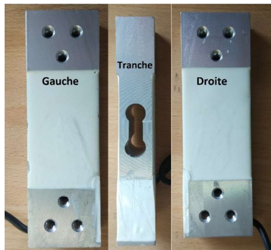
FIGURE 3.3 – Présentation d'une jauge de contrainte
