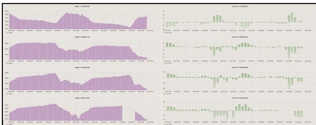
FIGURE 2.27 – Visualisation des données pour la recherche. Les graphiques représentent l'évolution du poids en kg (à gauche) et de la variation de masse (droite) au fil du temps sur quatre ruches.
