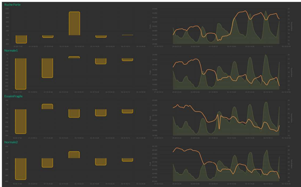
FIGURE 2.29 – Visualisation des données de pesée et des données traitées sur l'application dédiée aux apiculteurs. La courbe de droite montre l'évolution du poids (jaune) et de la température au fil du temps (vert). Le graphique de gauche illustre l'évolution quotidienne du poids pour une interprétation rapide des tendances.
