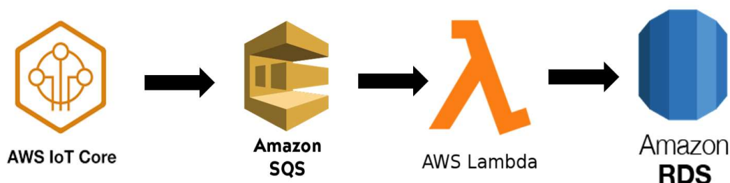
FIGURE 2.25 – Structure de réception et de stockage des données sur Amazon AWS
