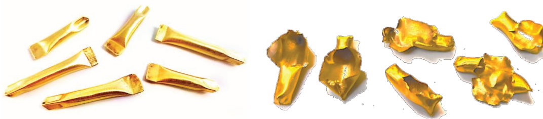
Figure 2.6. Capsules en or intactes (gauche) et capsules ayant subi un différentiel de pression trop important (droite).
