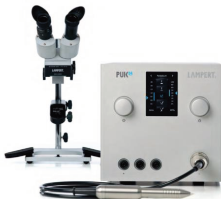
Figure 2.4. Poste à souder Lampert® PUK04 permettant de fermer hermétiquement les capsules en or.
