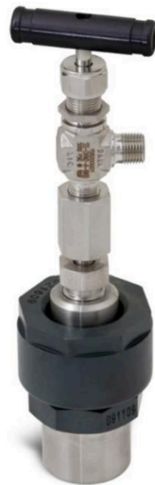
Figure 2.3. Photo du réacteur Parr® utilisé lors de cette thèse (modèle 4700, contenance 22 mL).
