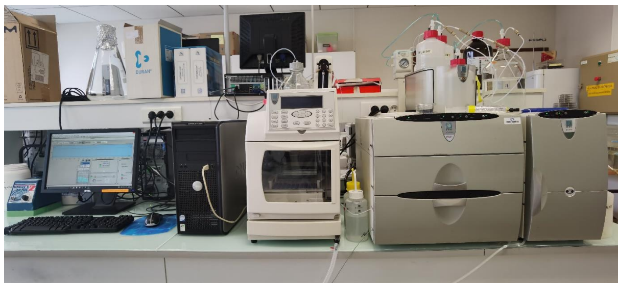
Figure 2.4 : Chaine de chromatographie ionique ICS 3000 (Dionex)
