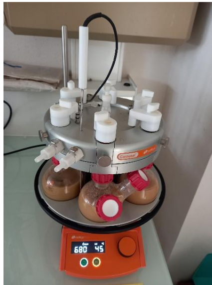
Figure 2.6 : Dispositif expérimental d'hydrolyse enzymatique de la biomasse (Radleys reactor)
